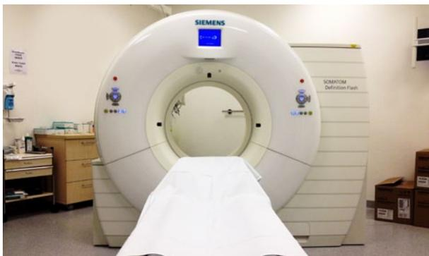
**Bild 01:** Der Computertomograph am St.-Marien-Hospital Bonn. Ein Siemens Flash CT welcher 256 Zeilen mit zwei versetzt arbeitenden Detektorfeldern ultraschnell ausliest. Dadurch können hochauflösende Bilder des gesamten Herzens in weniger als 300 Millisekunden aufgenommen werden.
